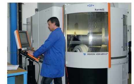
Auf diesen industriellen 5-Achsen Fräsmaschinen fräst allshape AG die hochpräzisen Suprastrukturen
